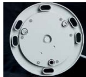
Установка Крепёжный фланец позволяет закрепить фонарь используя 3 или 4 болта M12 на окружности 200 мм, или 3 болта M8 на окружности 150 мм.
