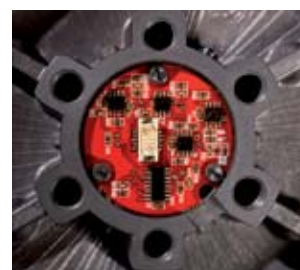
ОСОС Оптическая система с обратной связью (ОСОС) обеспечивает наблюдение за состоянием светодиодов.
