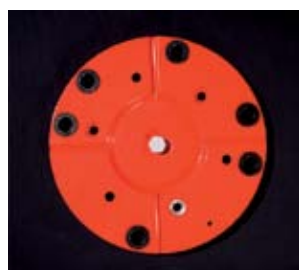
Монтаж Возможна установка на фонарный столик с помощью 3х болтов M12 на окружности 200мм. Монтажные отверстия изолированы пластиковыми прокладками. Фторопластовый клапан обеспечивает циркуляцию воздуха.
